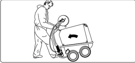
8. Když chcete tlačit stroj: Abyste mohli změnit směr, naklopte a točte přístroj tím, že šlápnete na nožní opěrku a zároveň táhnete za držadlo pro pojezd.
